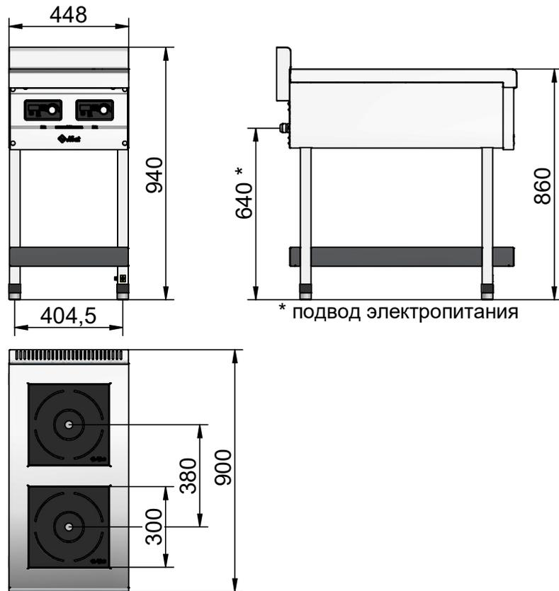
Плиты индукционные кухонные КИП-29П-3,5, КИП-29П-3,5-01, КИП-29П-5,0 и КИП-29П-5,0-01 предназначены для приготовления первых, вторых и третьих блюд в специальной наплитной посуде. Посуда должна быть с плоским дном, обладающая магнитными свойствами: посуда из нержавеющей стали или алюминия с ферромагнитным дном, чугунная посуда (посуда, к которой притягивается магнит).
